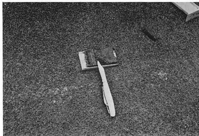
Bild 2 Wimbledon, Centre Court, Bodenaufbau, dünne Schichten als Folge der Besandung
