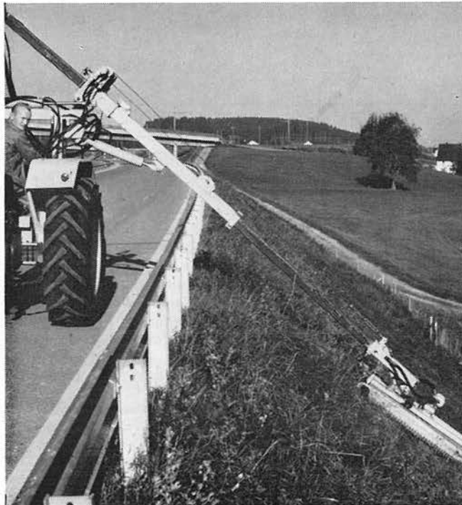
Abb. 11: Astron-Böschungsmäher im Einsatz an der N3. Für die vorwiegend aus Festuca rubra bestehende Grasnarbe genügen jährlich 2 Säuberungsschnitte; Kosten pro m 2 unter 20 Rappen.
